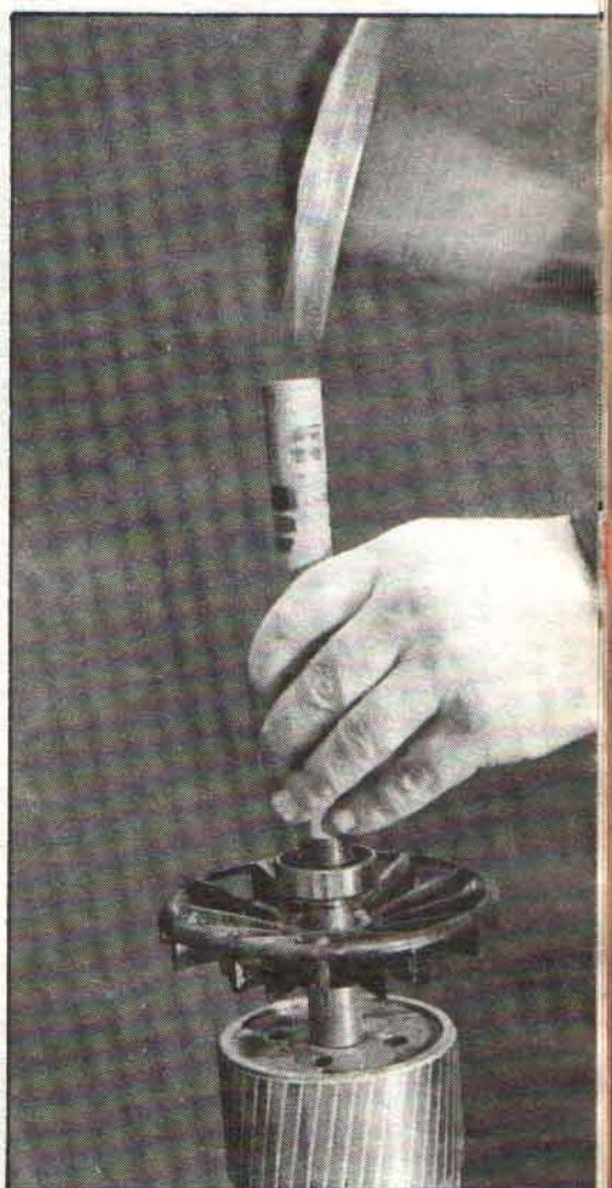
Nakon narezivanja navoja i čišćenja osovine možete postaviti ležaj, tako da ga rukom dovedete do dosjeda na koji više ne ide lako. Zatim uzmite cijev koja nasjeda na unutarnji obruc ležaja i čekićem ga nabijte. Ni u kom slučaju ne lupajte po vanjskom obodu ležaja. Donji kraj osovine oslonite o drvo.
